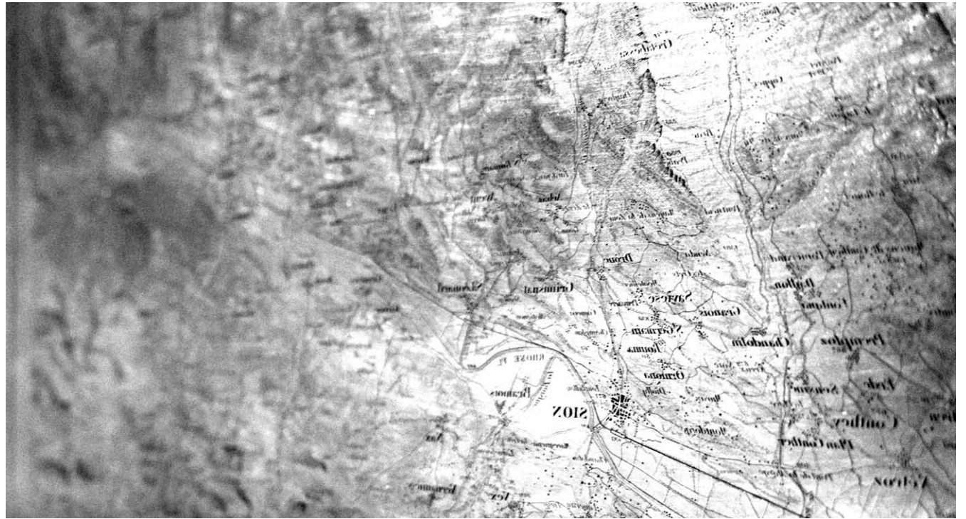
© Druckplatten für die «Topographische Karte der Schweiz 1:100 000» (Dufourkarte), Kupferplatten teilweise verstäht ab 1845.
