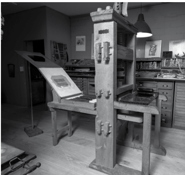
Spindelruckpresse, gebaut nach Vorlagen aus dem 16. Jahrhundert. Holz. Druckerei Altherr, Reitnau.
