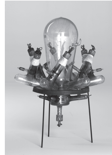
Quecksilberdampfgleichrichter, undatiert, Signum AG, Wallisellen. © Swiss Science Center Technorama, Winterthur. Foto: Donat Stuppan.
